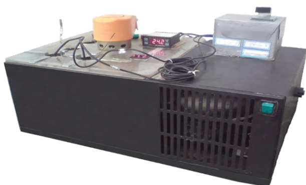
Fig. 2: Pour point measuring experimental setup
